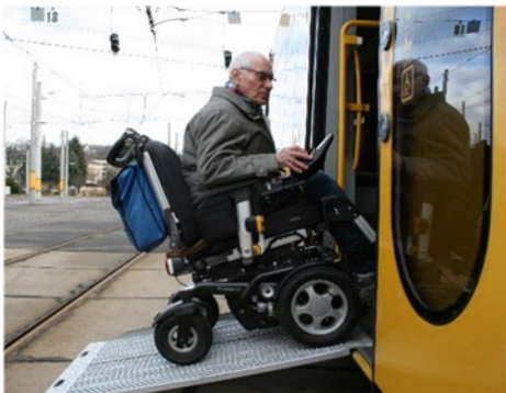
Im E-Rollstuhl mit Motorkraft mit mäßiger Geschwindigkeit in gerader Linie und in Rampenmitte einfahren
