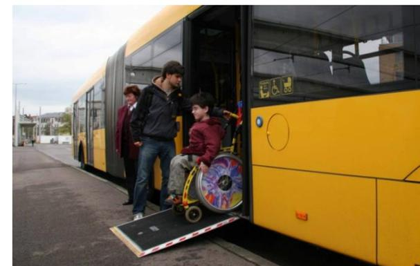
Training des Ein- und Ausfahrens an der fahrzeuggebundenen Rampe eines Niederflurbusses.
