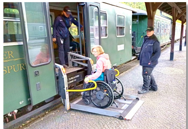
Einsatz des Hubliftes am Bahnhof Bertsdorf
