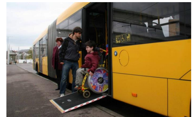
Training des Ein- und Ausfahrens an der fahrzeuggebundenen Rampe eines Niederflurbusses.
